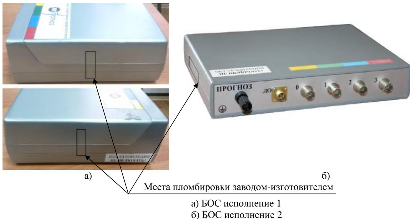
Рисунок 2 – Схема пломбирования от несанкционированного доступа
