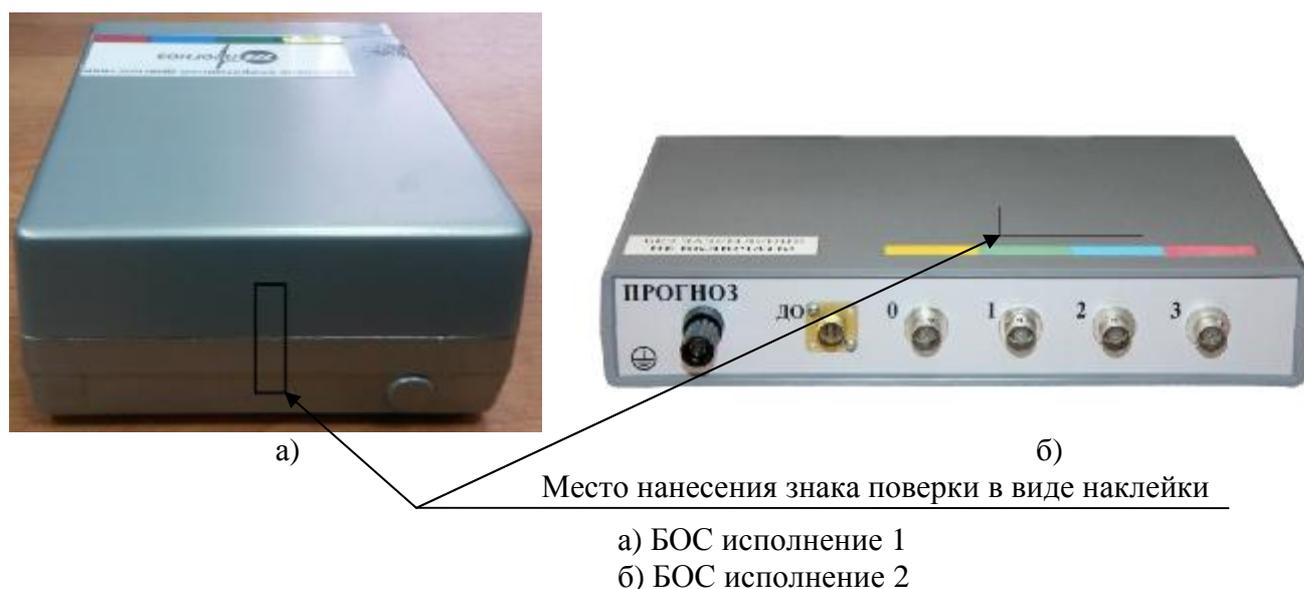
Рисунок 3 – Место нанесения знака поверки
