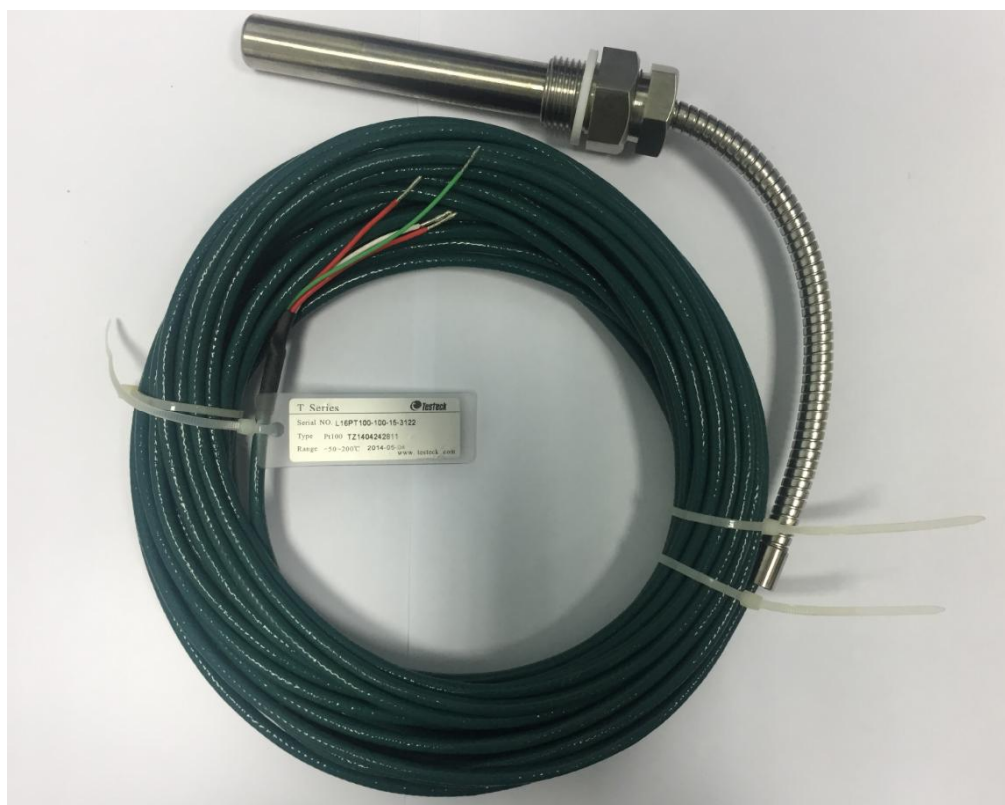
Рисунок 1 - Общий вид термопреобразователя сопротивления платинового L16Pt100-100-15-3122
