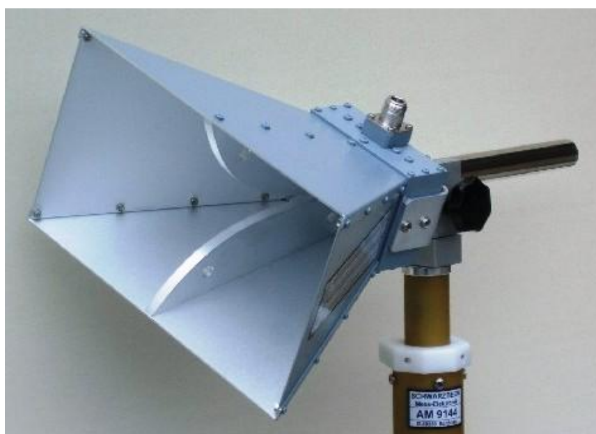
Рисунок 2 - Общий вид вспомогательной антенны ВВНА 9120 D
