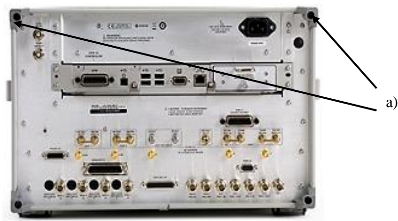
Рисунок 5 - Места пломбировки (а)
