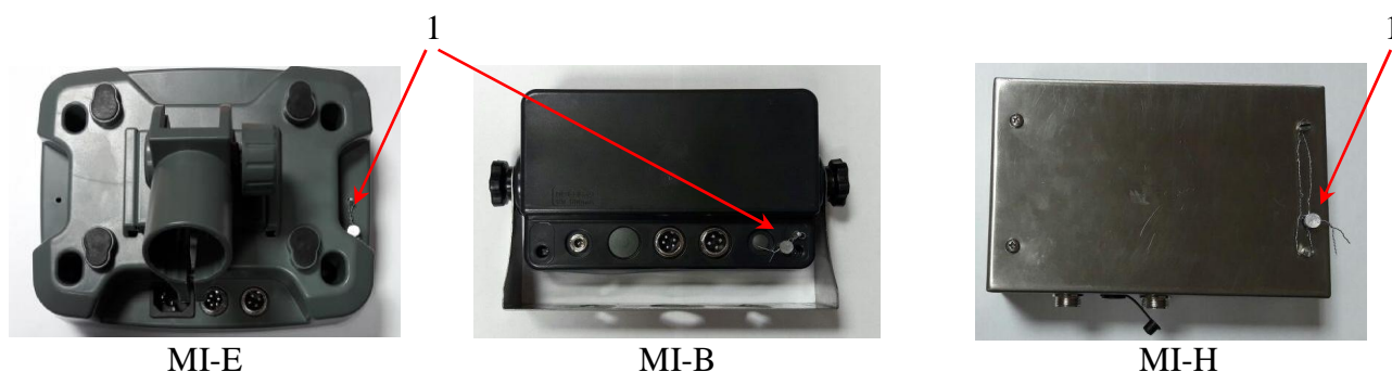
Рисунок 3 - Схема пломбировки от несанкционированного доступа, обозначение места нанесения знака поверки (1 - свинцовая или пластиковая пломба на которую наносится знак поверки в виде оттиска поверительного клейма)
