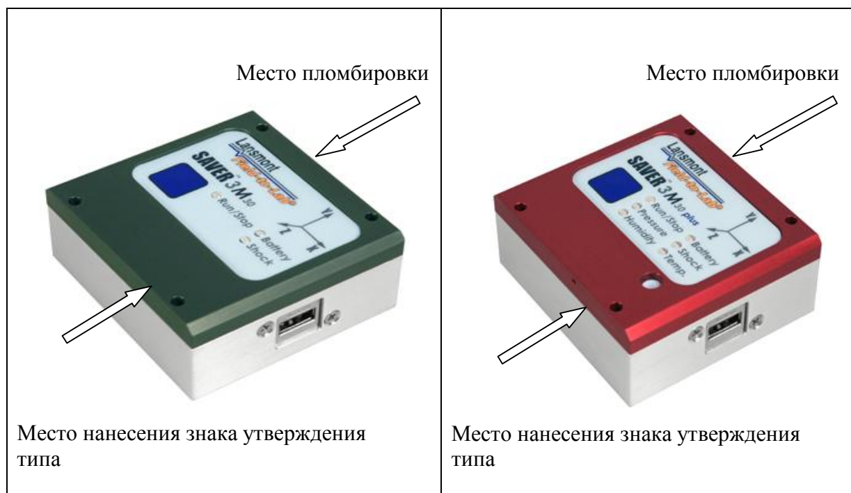
Рисунок 2 - Внешний вид регистраторов SAVER 3M30, SAVER 3M30 Plus, схема пломбировки от несанкционированного доступа и место нанесения знака утверждения типа
