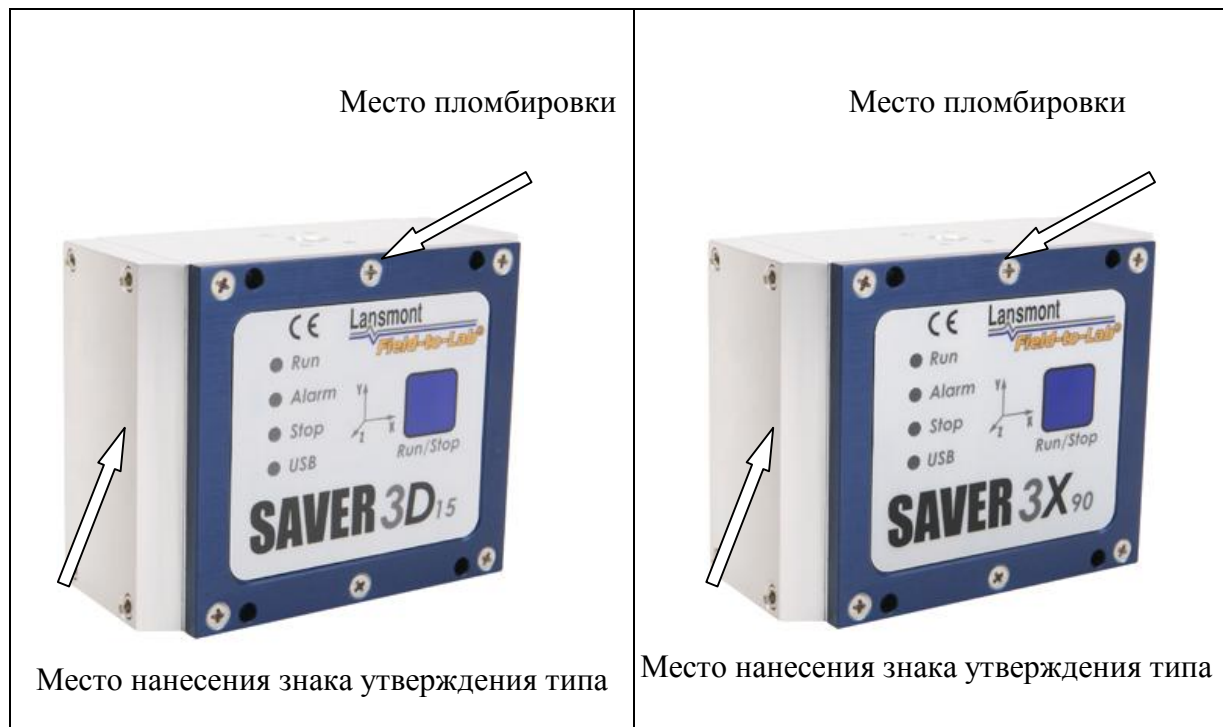
Рисунок 1 - Внешний вид регистраторов SAVER 3D15, SAVER 3X90, схема пломбировки от несанкционированного доступа и место нанесения знака утверждения типа
