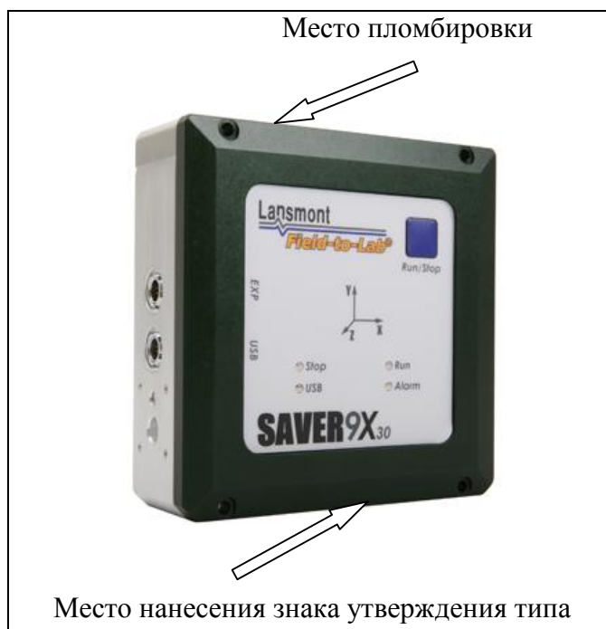
Рисунок 3 - Внешний вид регистратора SAVER 9X30, схема пломбировки от несанкционированного доступа и место нанесения знака утверждения типа
