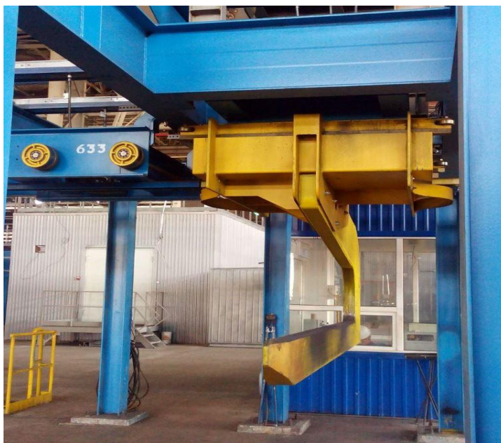
Рисунок 1 - Общий вид весов товарных встроенных SUNDCO H
