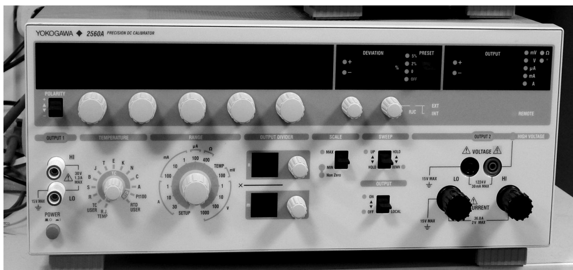
Рисунок 1 - Внешний вид источников напряжения и силы постоянного тока эталонных 2560A
