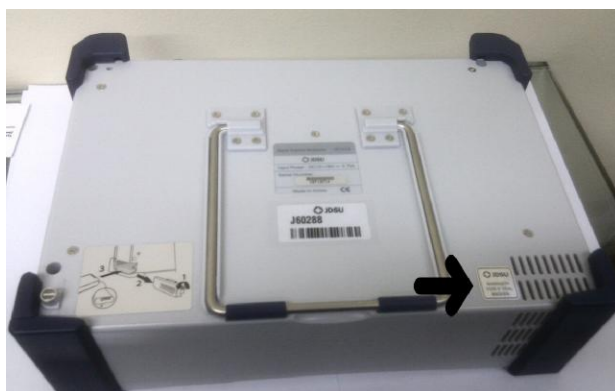
Рисунок 4 - Схема пломбирования анализаторов от несанкционированного доступа
