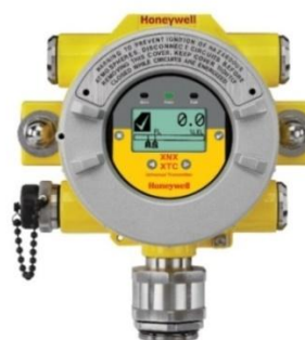
Рисунок 2 - Общий вид газоанализаторов XNX XTC с сенсором MPD
