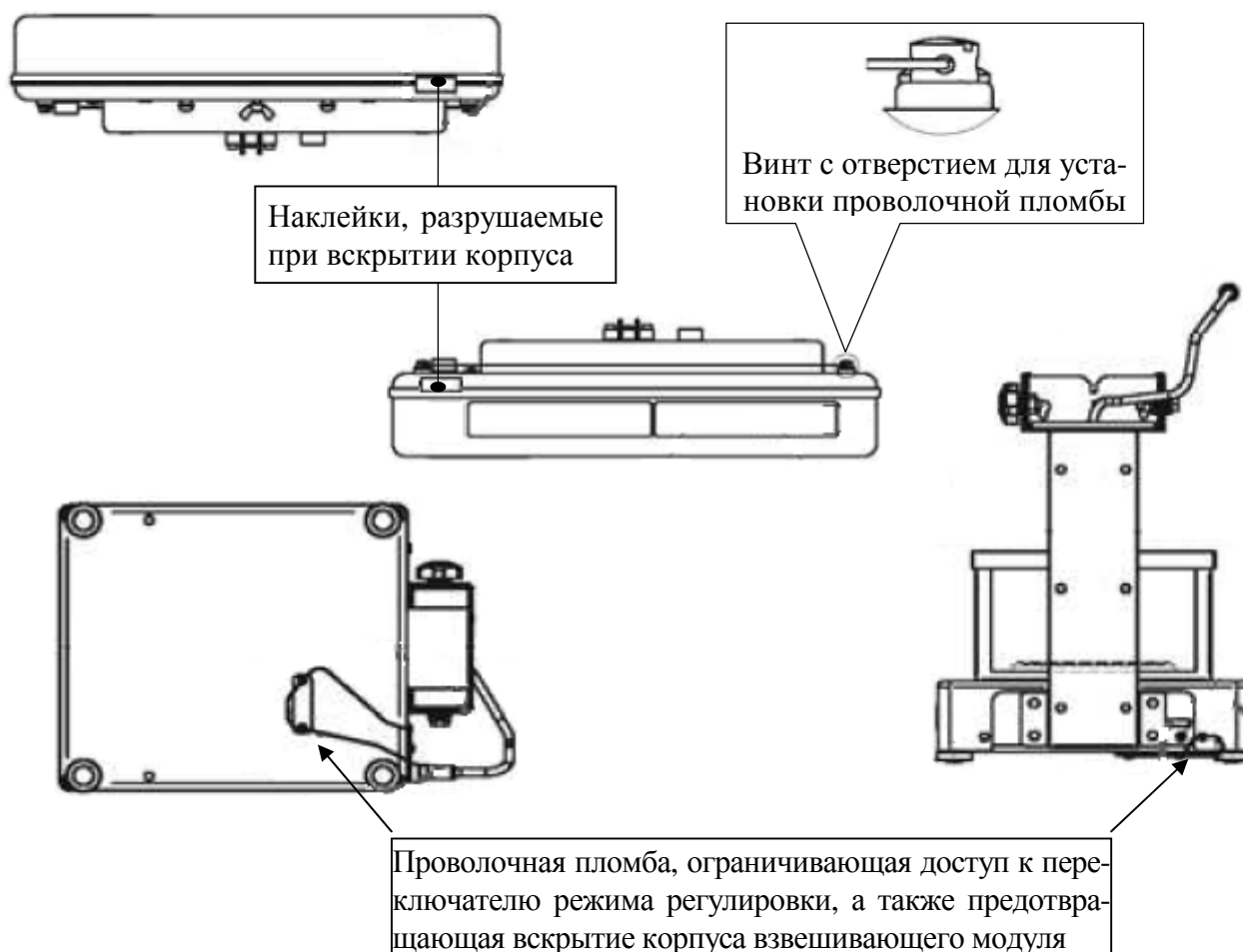
Рисунок 2 - Схема пломбировки от несанкционированного доступа
