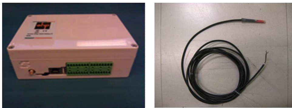
Рисунок 2 - Общий вид даталоггера DL12 и датчика температуры производства компании “EHP-Tekniikka Ltd.” из состава систем
