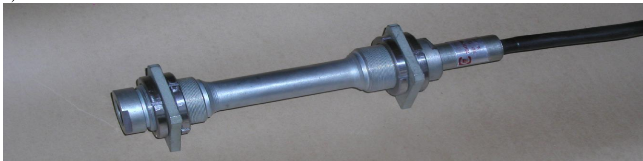
Рисунок 1 - Внешний вид тензометров струнных: а) закладной ТБ 200-ВНИИГ.З; б) накладной ТБ 200-ВНИИГ.Н
