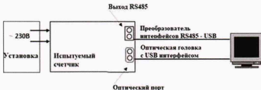
Рисунок 1 - Рабочее место для конфигурирования испытательного выхода счетчика.
