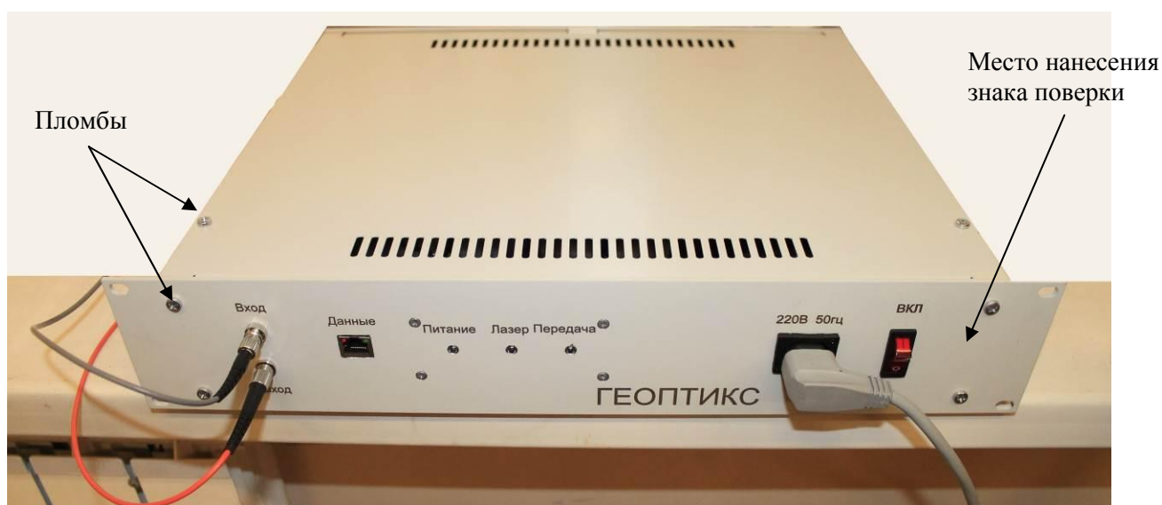
Рисунок 2 - Общий вид электронно-вычислительного блока средства измерений и схема пломбировки от несанкционированного доступа, обозначение места нанесения знака поверки
