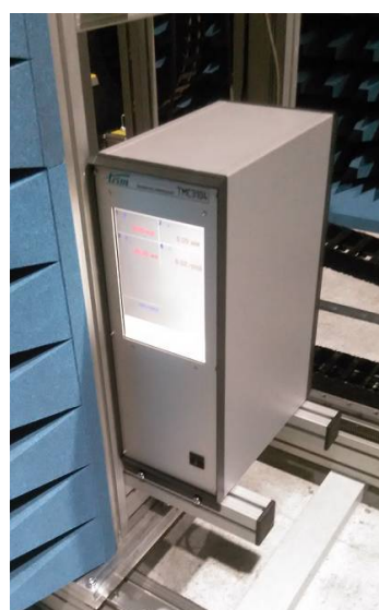
Рисунок 3 - Внешний вид рупорной антенны и контроллера управления сканером
