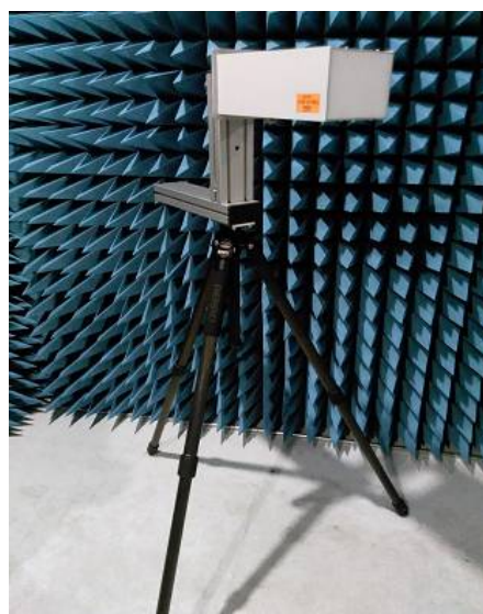
Рисунок 3 - Внешний вид рупорной антенны и контроллера управления сканером
