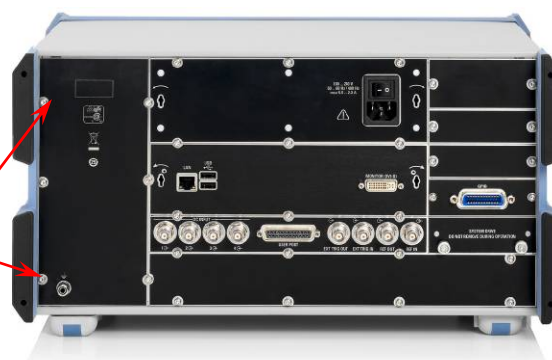
Рисунок 6 - Задняя панель векторного анализатора цепей
