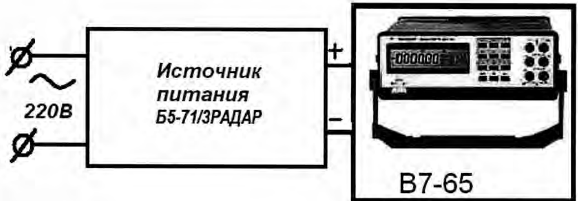
Рисунок 8.1 – Схема определения абсолютной погрешности воспроизведения выходного напряжения, абсолютной погрешности измерения выходного напряжения ИП в режиме стабилизации напряжения
