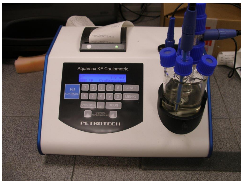
Рисунок 1 - Анализатор влажности кулонометрический Aquamax KF
