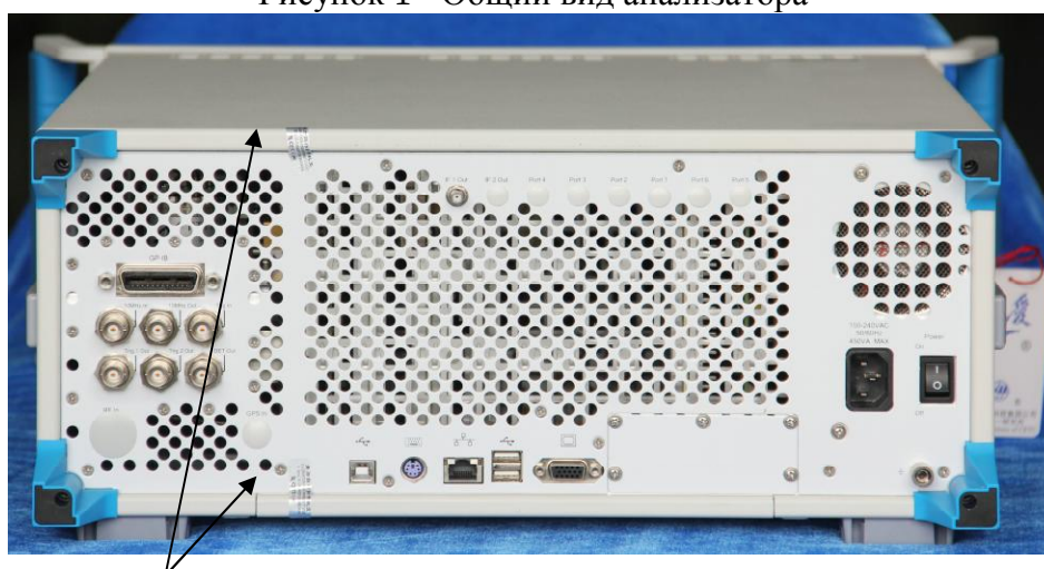
Рисунок 2 - Схема пломбировки от несанкционированного доступа
