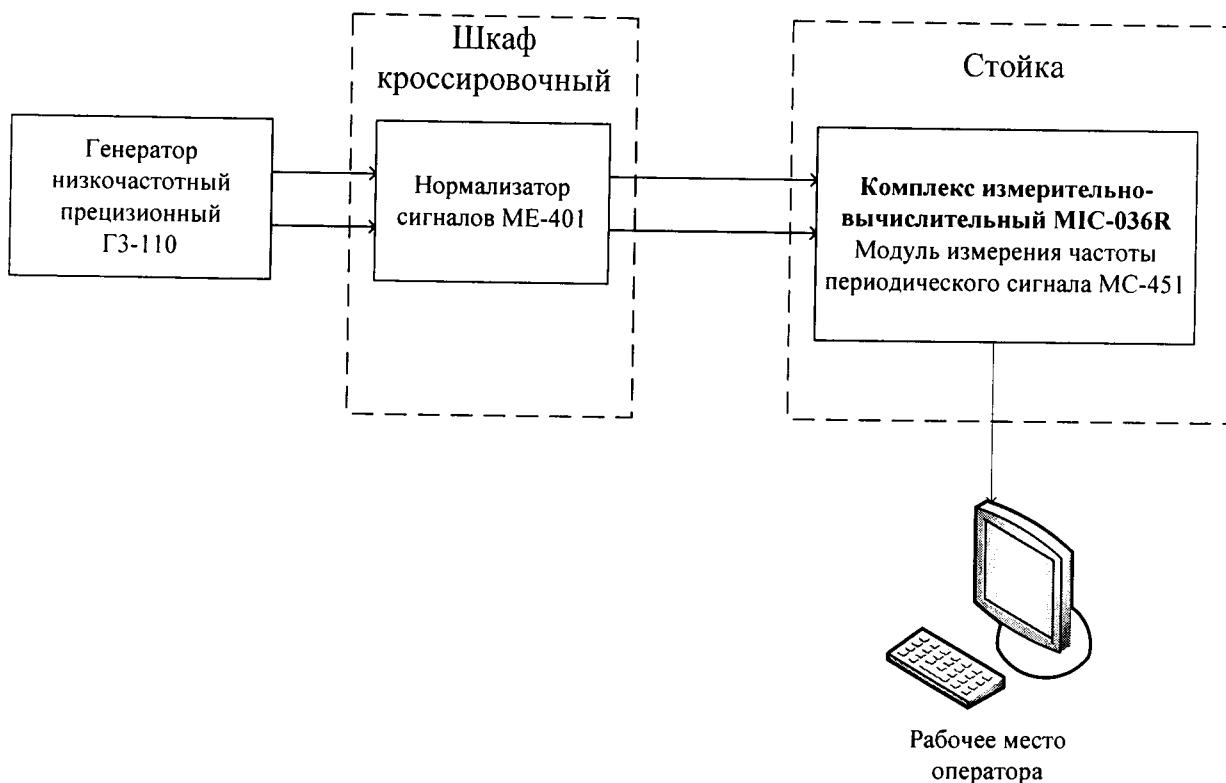
Рисунок 10 – Схема поверки ИК частоты периодического сигнала
