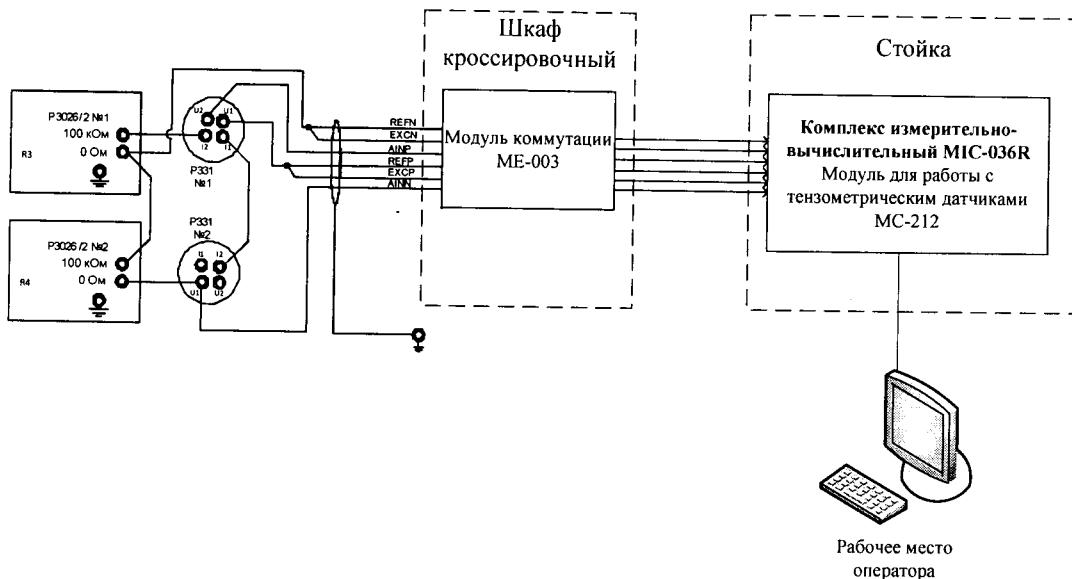
Рисунок 15 – Схема поверки ИК относительного напряжения постоянного тока
