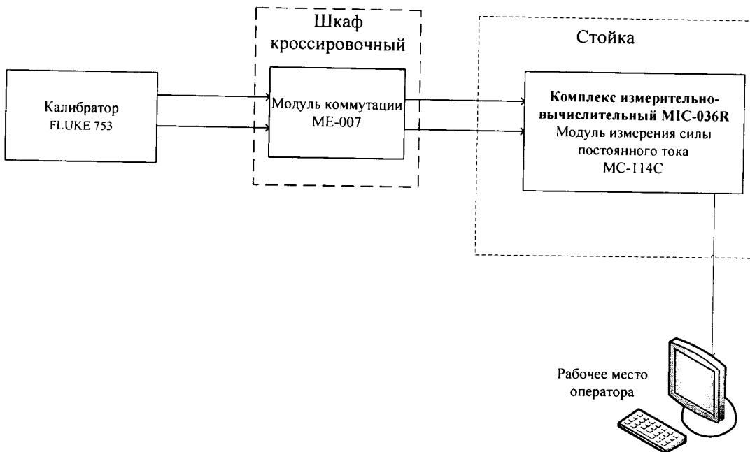
Рисунок 11 – Схема поверки ИК силы постоянного тока
