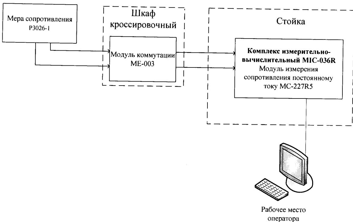
Рисунок 13 – Схема поверки ИК сопротивления постоянному току
