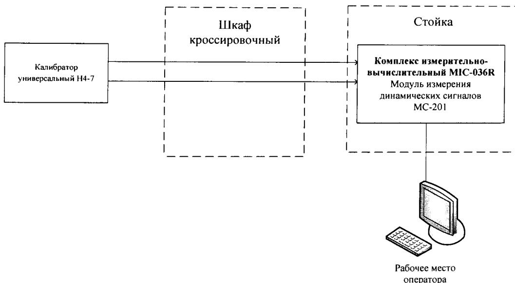
Рисунок 14 – Схема поверки ИК напряжения переменного тока
