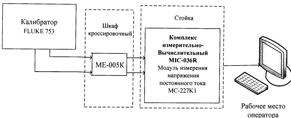
Рисунок 12 – Схема поверки ИК напряжения постоянного тока
