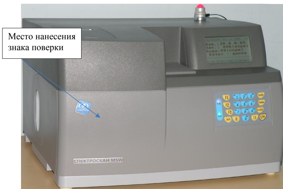
Рисунок 1 - Внешний вид анализатора СПЕКТРОСКАН MSW
