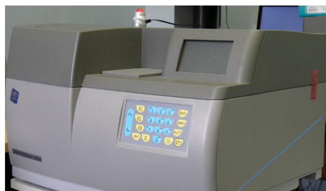
Рисунок 1 - Внешний вид анализатора СПЕКТРОСКАН MSW
