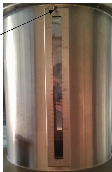
Рисунок 2 - Общий вид шкалы измерительной горловины с местом пломбировки
