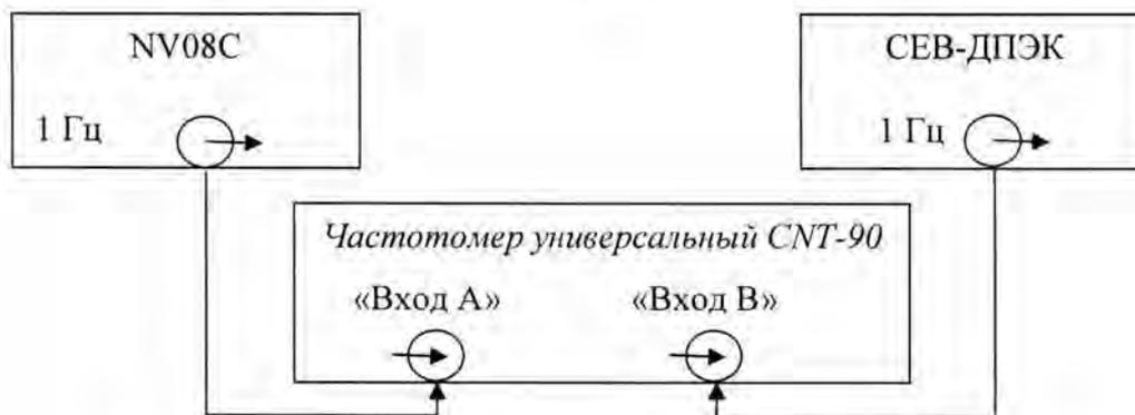
Рисунок 1 – Схема определения относительной погрешности по частоте
