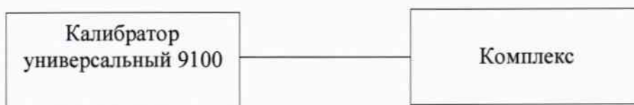
Рисунок 1 – Структурная схема подключения комплекса для проверки пределов допускаемой приведенной (к значению полной шкалы диапазона) погрешности измерения силы постоянного тока
