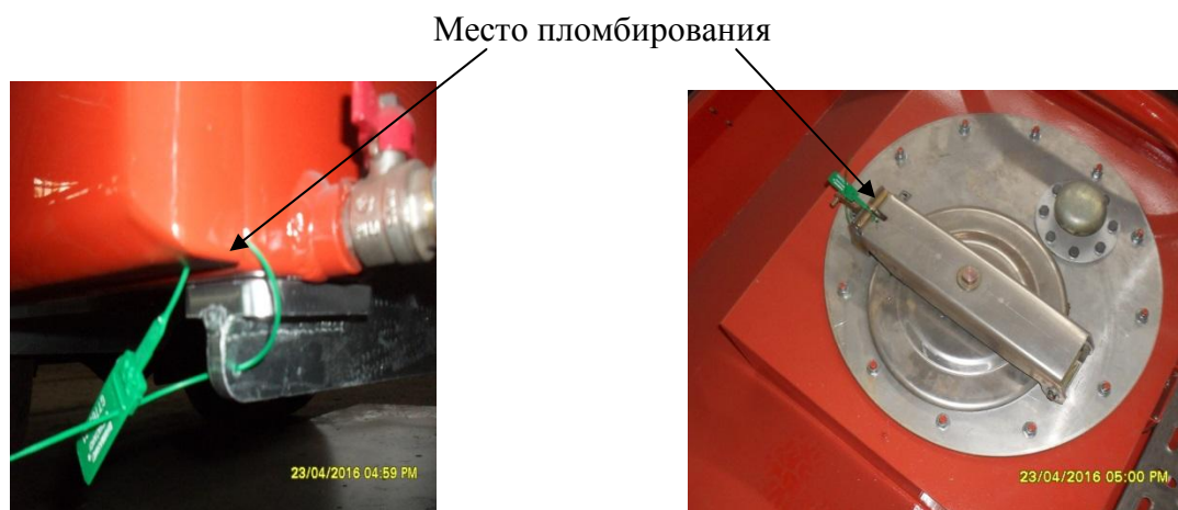
Рисунок 3 - Схема пломбирования от несанкционированного доступа
