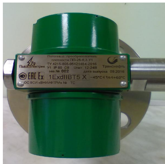
Рисунок 2 - Общий вид преобразователя ПП-25-6,3.У1
