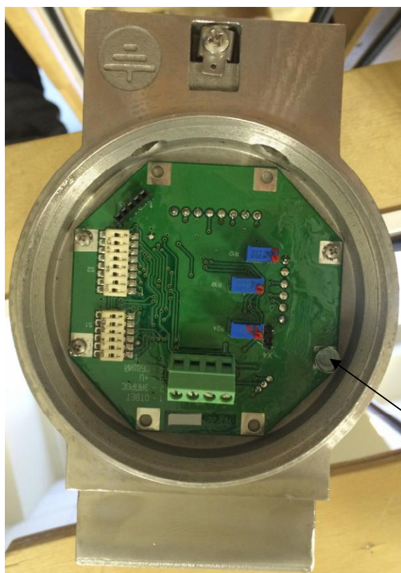
Рисунок 2 - Схема пломбировки от несанкционированного доступа
