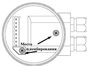
Рисунок 2 - Схема пломбировки расходомеров-счетчиков электромагнитных ПИТЕРФЛОУ
