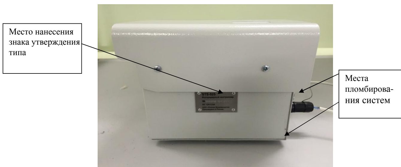
Рисунок 3 - Схема пломбировки контроллеров от несанкционированного доступа и место нанесения знака утверждения типа
