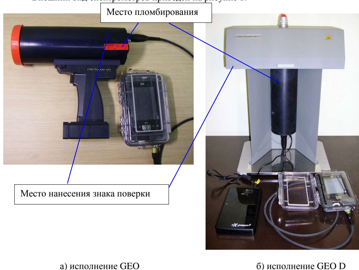
Рисунок 1 - Спектрометр рентенофлуоресцентный энергодисперсионный портативный СПЕКТРОСКАН GEO
