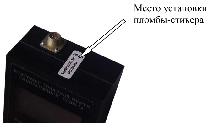
Рисунок 2 - Место пломбирования влагомеров нефти лабораторных УДВН-1л
