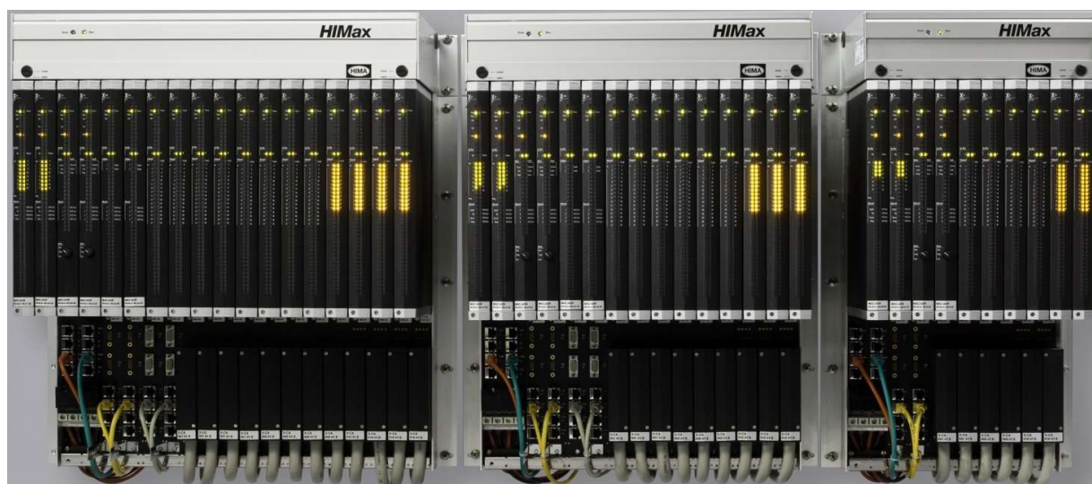
Рисунок 1 - Фотография общего вида системы с комплектацией 18, 15 и 10 модулями
