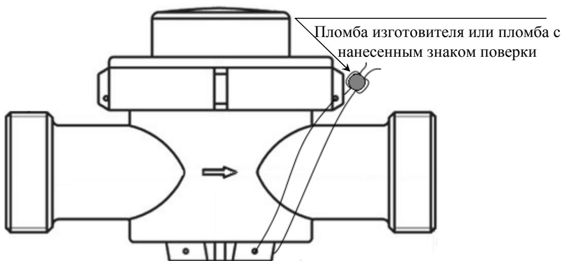
Рисунок 6 - Схема пломбировки счетчиков с Ду 25 мм, 32 мм, 40 мм и 50 мм
