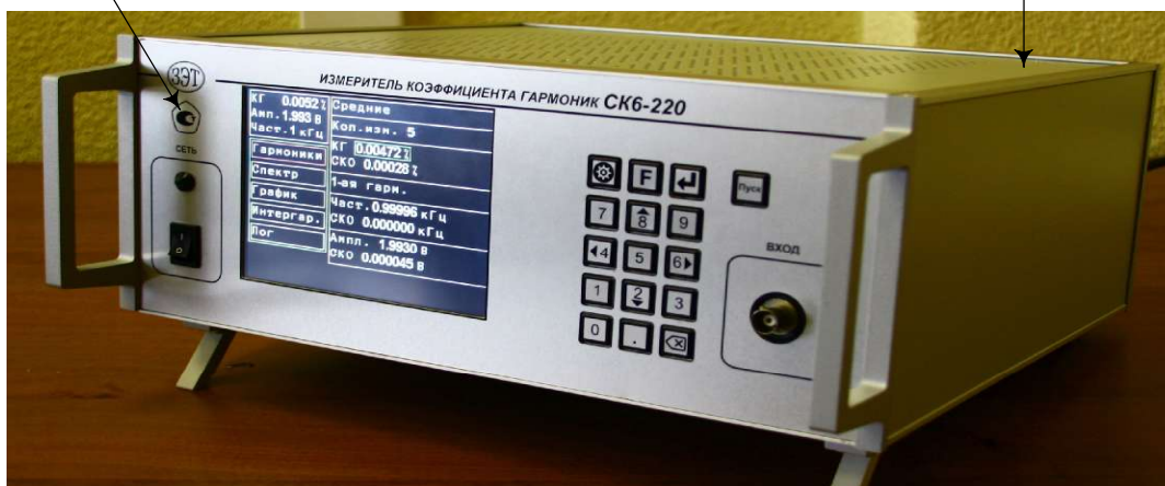
Рисунок 1 - Внешний вид измерителя СК6-220 с указанием мест пломбирования и размещения знака утверждения типа
