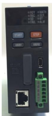
Рисунок 2 - Фотография основного модуля системы сбора данных GM10
