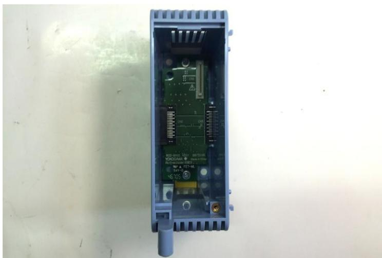
Рисунок 4 - Фотография базы для модулей GM90MB
