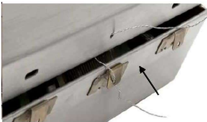
Рисунок 3 - Схема пломбировки корпуса терминала от несанкционированного доступа
