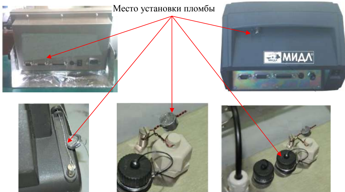
Рисунок 9 - Схема пломбировки весоизмерительных приборов МИ
