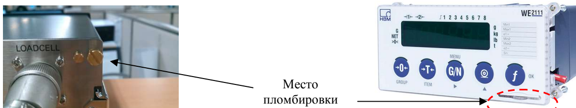
Рисунок 4 - Схема пломбировки приборов весоизмерительных CI-600D (свинцовый пломбой), WE2111 (с помощью разрушаемой наклейки)
