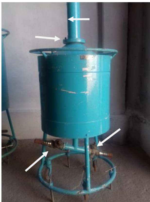
Рисунок 1 - Общий вид и места пломбирования мерника
