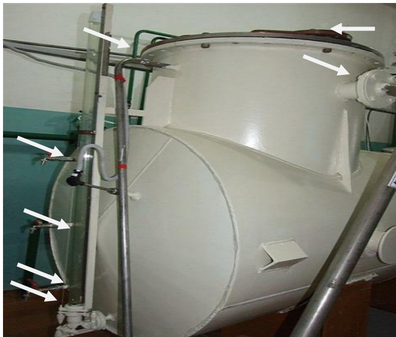
Рисунок 1 - Общий вид и места пломбирования мерника
