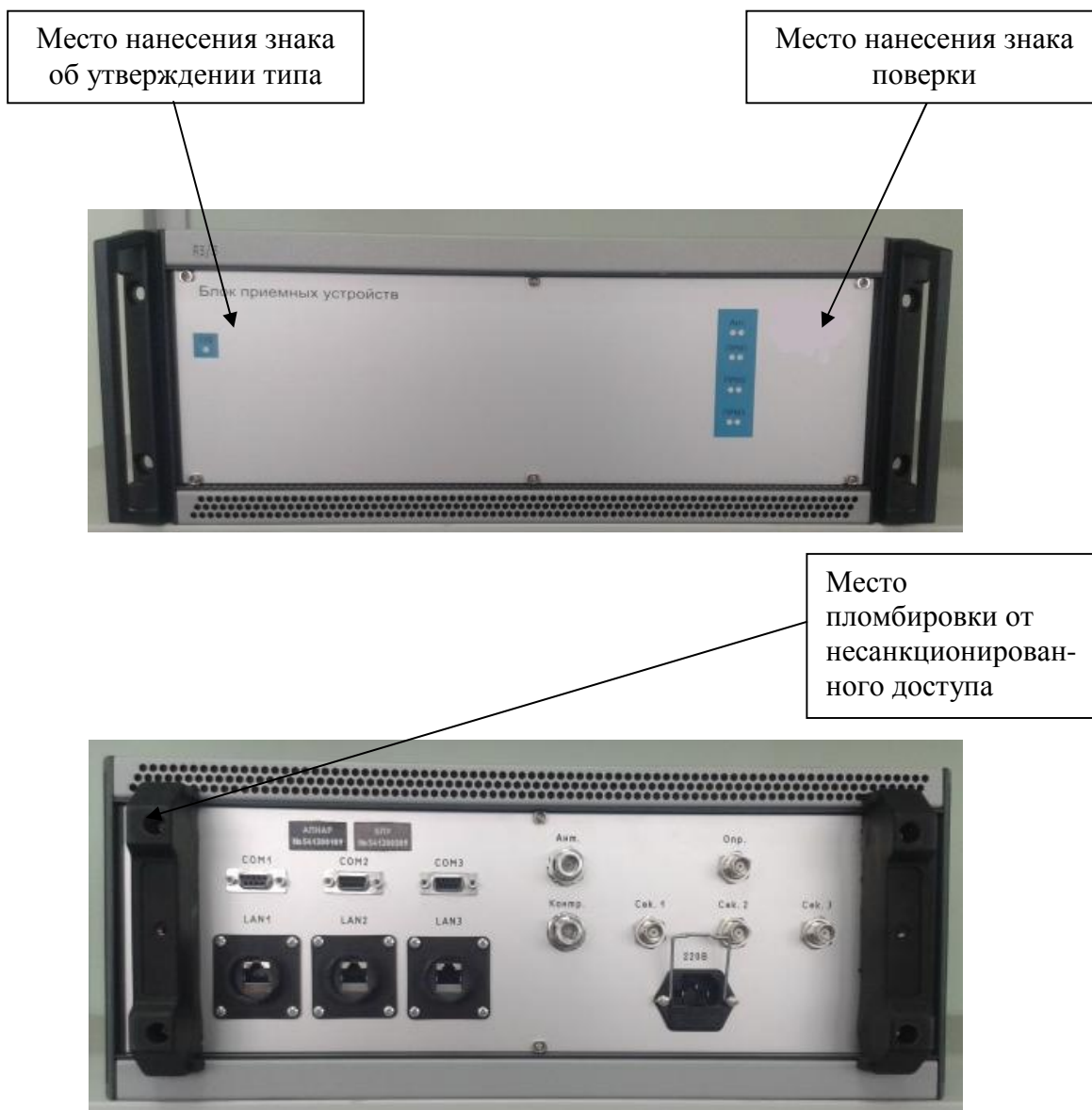
Рисунок 3 - Внешний вид блока приемных устройств и мест нанесения знака (наклейки) об утверждении типа, знака поверки и пломбировки от несанкционированного доступа
