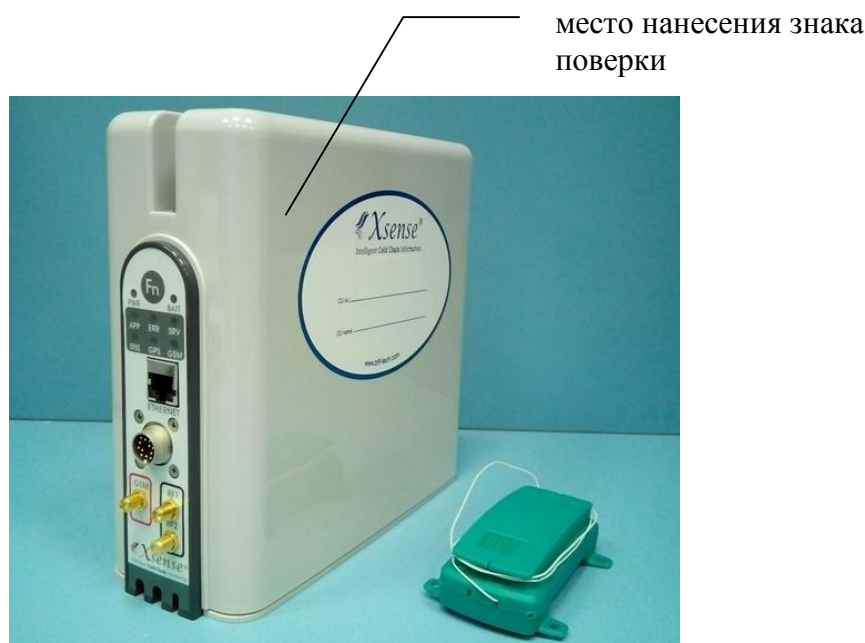
Рисунок 1 - Общий вид системы мониторинга температуры и относительной влажности Xsense
