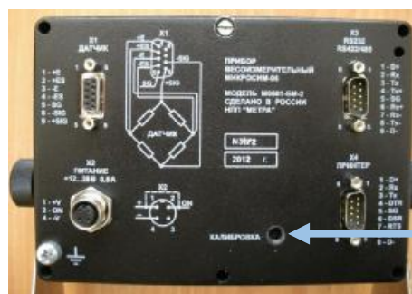
Рисунок 2 - Места пломбирования терминала М0601 для нанесения знака поверки
