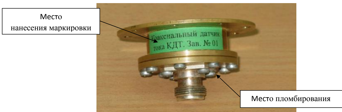
Рисунок 2 - Общий вид шунта коаксиального датчика тока КДТ с обозначением мест нанесения маркировки и пломбирования
