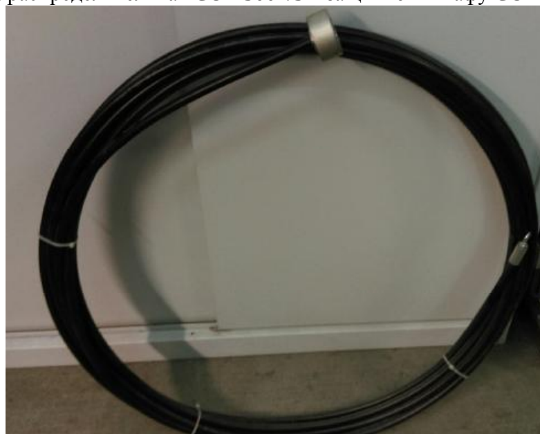
Рисунок 3. Термоподвеска в защитной полимерной оболочке
