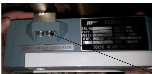
Рисунок 2 - Обозначение места пломбировки ротаметров М-901
