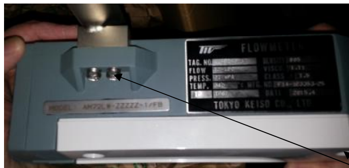
Рисунок 2 - Обозначение места пломбировки ротаметра М-901
