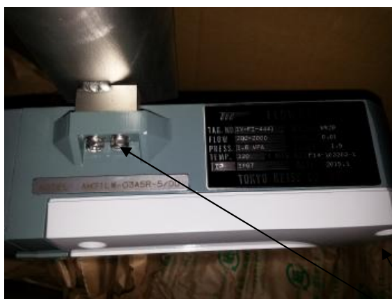
Рисунок 1 - Общий вид ротаметра AM71LW
