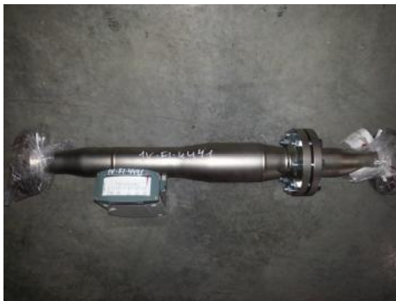
Рисунок 1 - Общий вид ротаметра AM71LW
