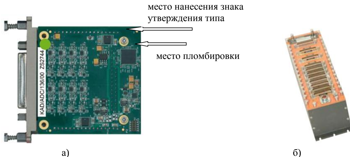
Рисунок 1 - Общий вид модуля (а) и модуля, установленного в блок базовый КАМ/CHS/13U (б)
