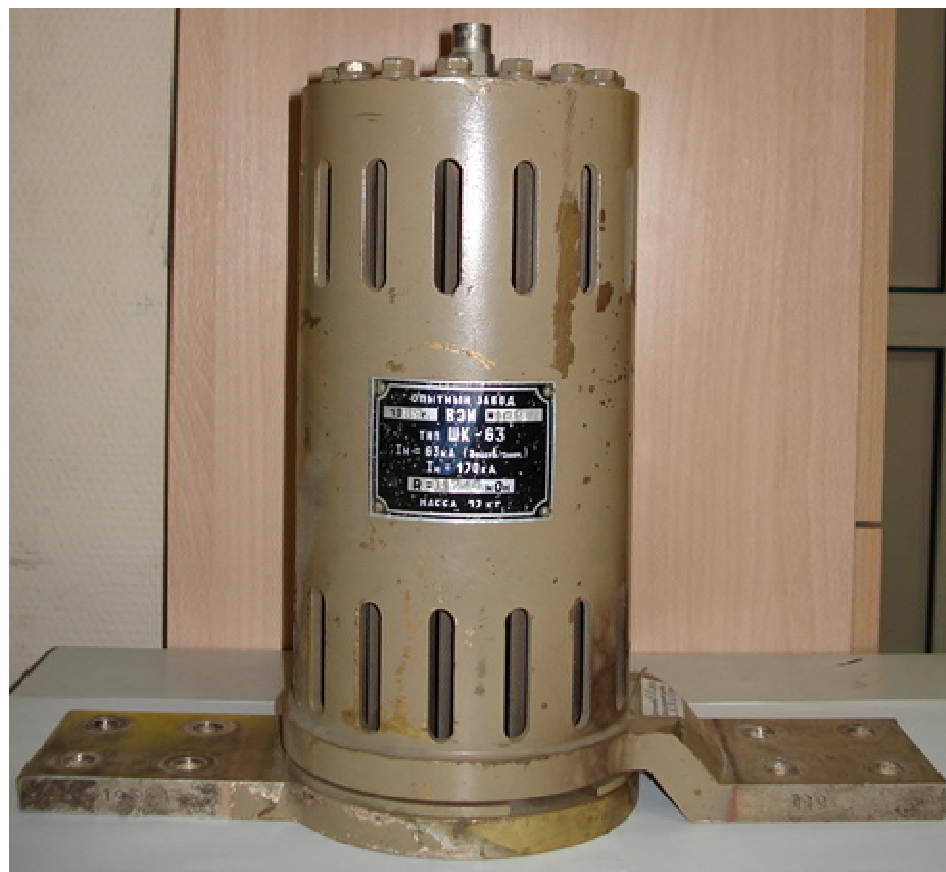
Рисунок 3 – Шунт измерительный коаксиальный ШК-63
