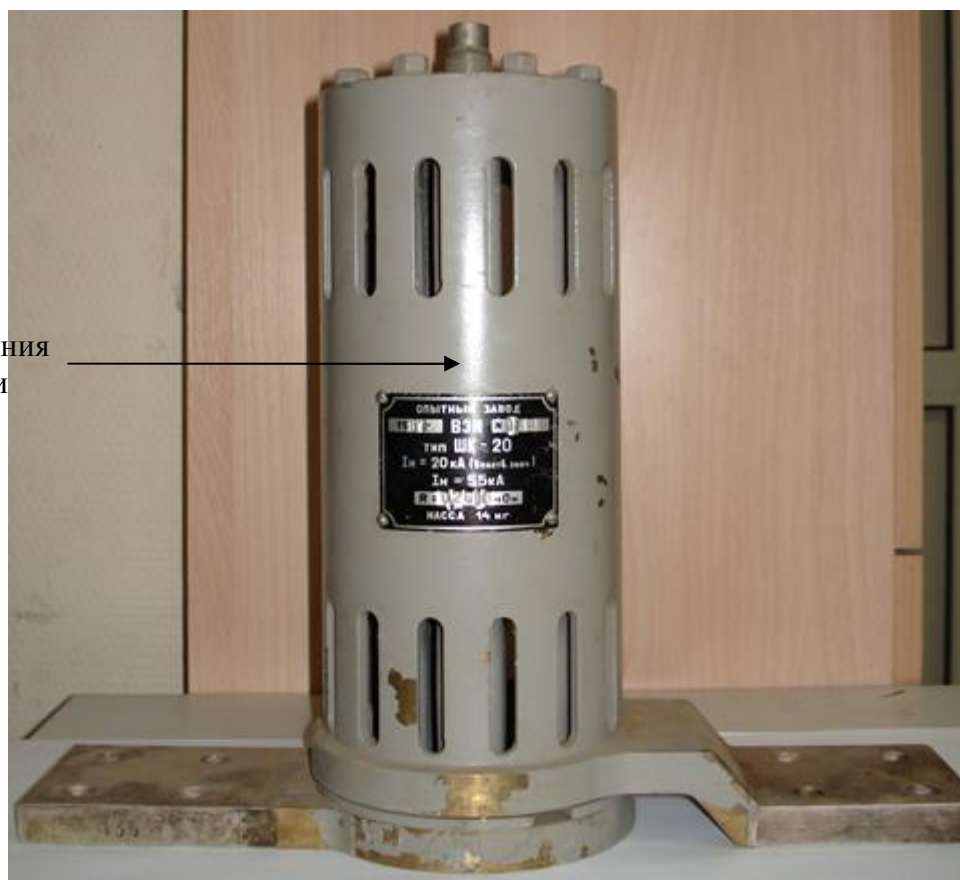
Рисунок 2 – Шунт измерительный коаксиальный ШК-20
