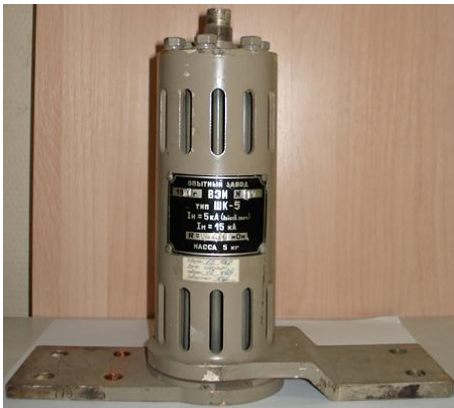
Рисунок 1 – Шунт измерительный коаксиальный ШК-5
