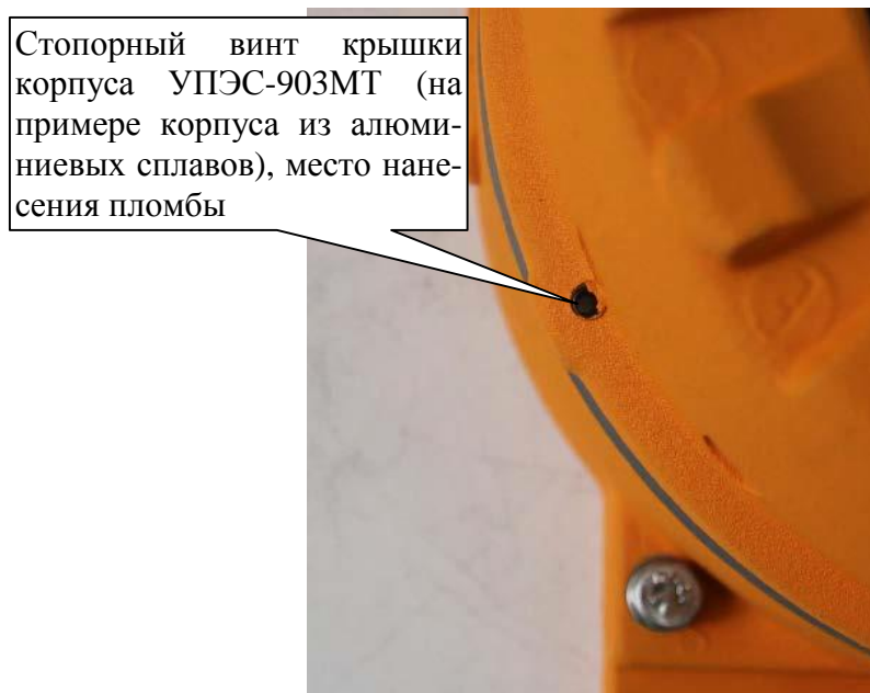
Рисунок 4 - Схема пломбировки газоанализаторов от несанкционированного доступа
