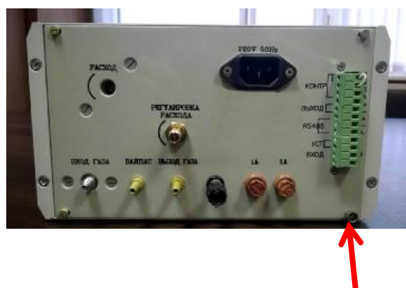
Рисунок 1. Схема пломбирования Гигрометра БАЙКАЛ МК однокорпусного.
