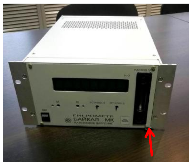
Рисунок 1. Схема пломбирования Гигрометра БАЙКАЛ МК однокорпусного.
